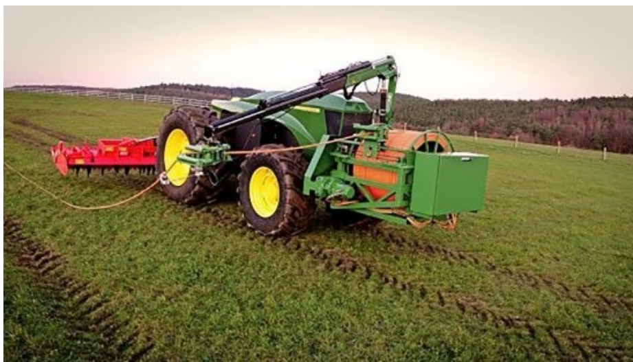
Figur 4.1 Selvkjørende elektrisk traktor fra John Deere med strømkabel.
